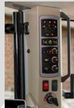
In dem Einstellbereich für die elektronische Hubwerksregelung können auch andere Heckhubwerksfunktionen eingestellt und die Produktivität erhöht werden.
