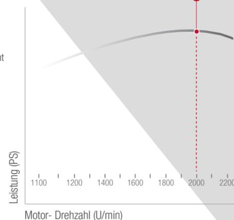
Diese Kurve zeigt deutlich, dass ein hohes Drehmoment zwischen 1.300 U/min und 1.900 U/min anliegt, um ein besseres Drehmomentvermögen und eine konstante Zapfwelldrehzahl zu gewährleisten.
