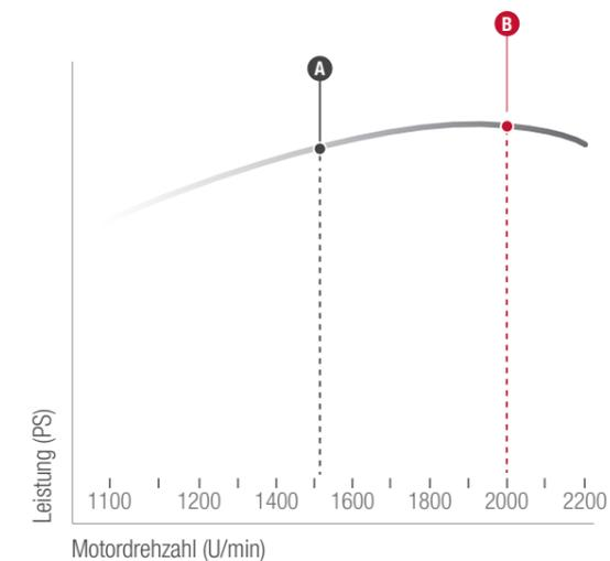
Die verfügbaren Zapfwellendrehzahlen sind so auf die Motordrehzahl abgestimmt, dass die Leistungs- und Drehmomentmerkmale der AGCO Power Motoren optimal genutzt werden können, um mit möglichst wenig Kraftstoff ein Höchstmaß an Produktivität und Effizienz zu erreichen.
