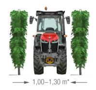
Der MF 3VI ist dank seiner geringen Breite ab 1,00 m ideal für Arbeiten in Weinbergen mit schmalen Abständen zwischen den Zeilen. Das Modell ist nur mit Kabine erhältlich und verfügt über 75 bis 120 PS.
