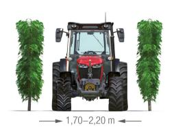
Ab einer Breite von 1,70 m und mit einer breiteren Vorder- und Hinterachse eignet sich das Modell für den Wein- und Obstbau in Hanglage. Dieser Traktor verfügt über eine besonders geräumige Kabine und liefert eine Leistung von 75 bis 120 PS. Der MF 3WF ist auch in einer Plattformversion mit bis zu 105 PS erhältlich.
