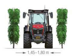
Ab 1,45 m Breite ist der MF 3FR ideal für weit auseinanderliegende Rebzeilen und Obstplantagen. Ein gut ausgestatteter Traktor mit breiterer Vorderachse und geräumigerer Kabine, erhältlich von 75 bis 120 PS sowie in einer Plattformversion mit bis zu 105 PS.
