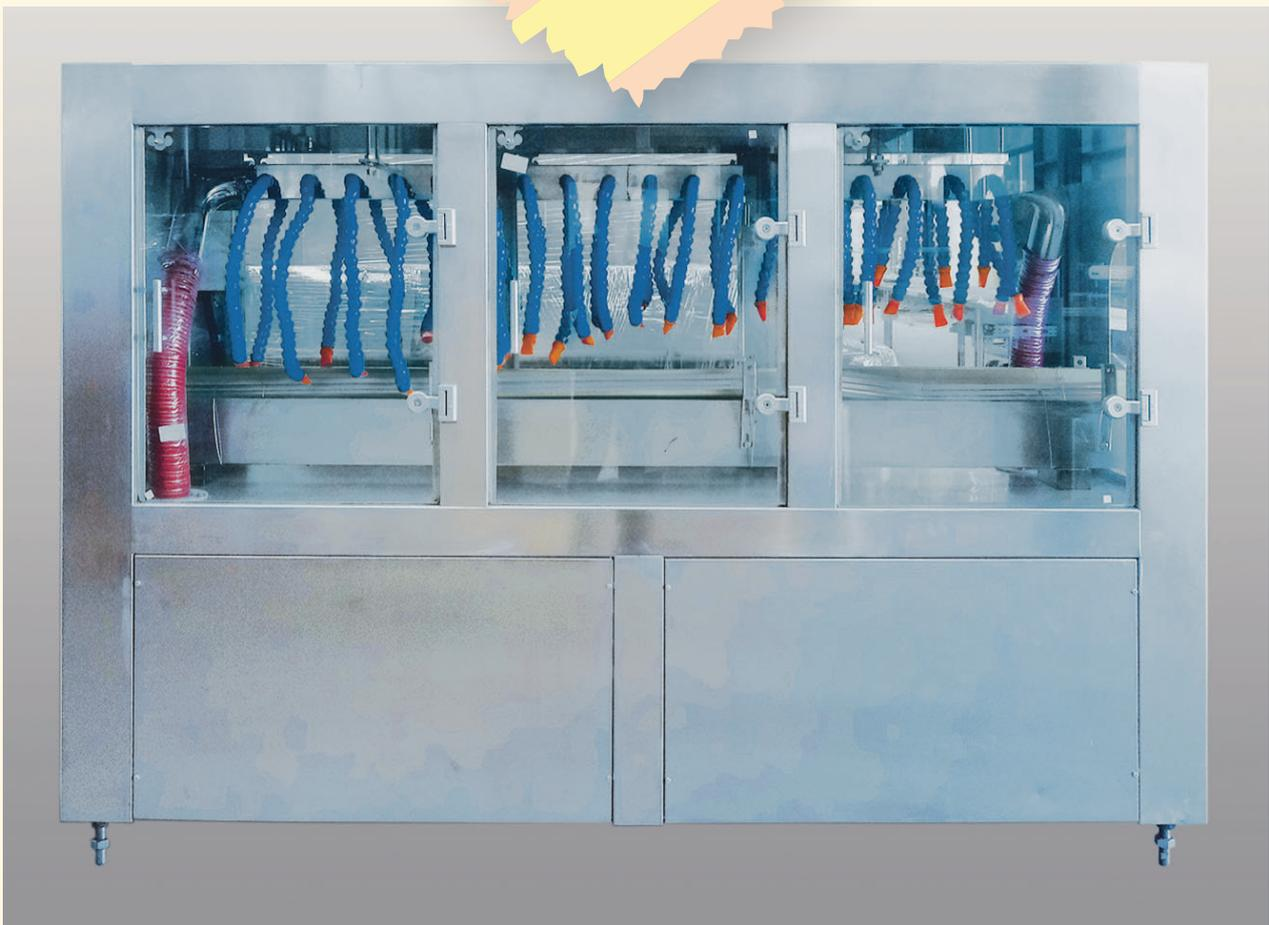
Trockner für Wein- u. Saftflaschen mit vollautomatischer Sortierung
