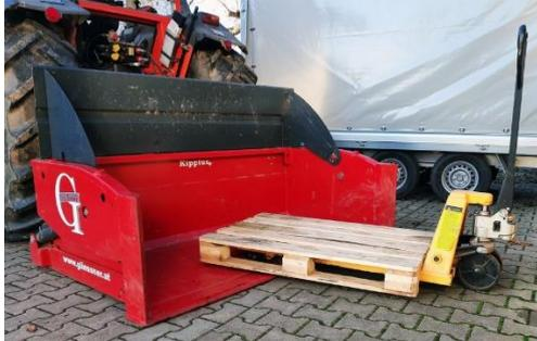
Auch das Eindringen in Schüttgüter und die Planie werden durch die Bauweise vereinfacht. Die in den stabilen Seitenwänden verbauten Zylinder sind dabei bestens geschützt. Dank 90° Auskippwinkel lassen sich selbst anhaftende Massen gut entleeren. Zusätzlich ermöglicht die äußerst kompakte Bauform, dass der Lastschwerpunkt sehr nah an der Lastaufnahme liegt.
