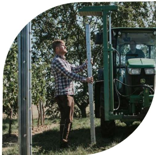
Die Pfahldrücker von CFS zeichnen sich durch eine robuste Bauweise und einfache Montage aus. Die Montagemöglichkeit in Front, Heck und Zwischenachs schaffen die gewünschte Bedienungs-freundlichkeit.
