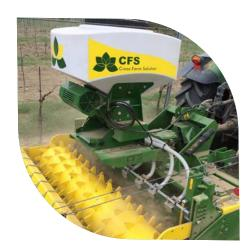
Durch die Montage der Prallteller auf der höhenverstellbaren Planierschiene ist auch bei Verstellung der Schienenhöhe immer eine optimale Ablage gegeben. Die Möglichkeit der Winkelverstellung der Prallteller schafft eine Vielzahl von Möglichkeiten und Anpassungen bei verschiedensten Saatgütern.
