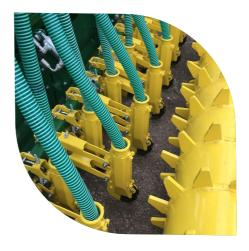
Der Präzisionssäbalken ist für eine optimale Saatgutablage bei großkörnigen Saatgütern bestens geeignet. Auch bei trockenen Bedingungen bringt er es durch die Ablage auf 2 – 5 cm Saattiefe. Die danach folgende Rückverfestigungswalze schafft optimale Aufwuchsbedingungen.
