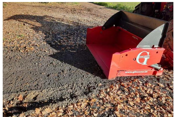
Zum Planieren ist der flache Schaufelboden optimal.
