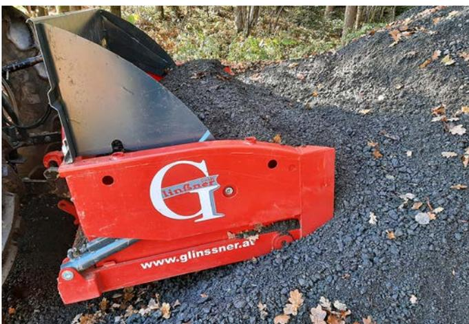
Das Eindringverhalten in Schüttgut gleicht dem eines Frontladers.
