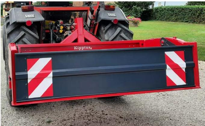
Die optionale Heckklappe lässt sich nach oben schwenken und verriegeln, beispielsweise als Bordwanderhöhung und Anschlag beim Holztransport.
