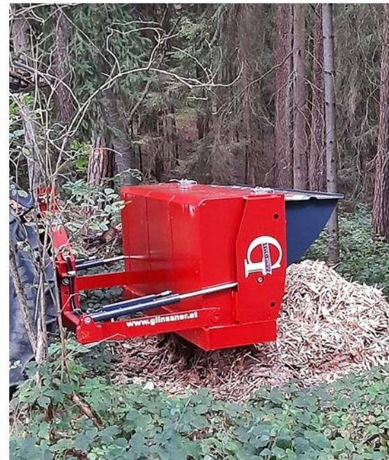
Steckungen aus dem Zubehörprogramm erhöhen die Ladefläche. Durch das Schlepper-Hubwerk ist das Holz beim Be- und Entladen immer in angenehmer Höhe erreichbar.
