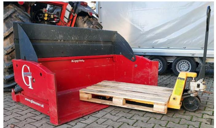
Mit stehender Heckklappe können Hubwagen ohne Anstieg direkt in die Heckschaufel gefahren werden.
