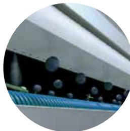
Die Düsen der Druckluftdüsenleiste entfernen die unerwünschten Elemente aus dem Lesegut (Grünabfälle, unreife Beeren oder Beeren in schlechtem Zustand, vertrocknete Beeren etc.).
