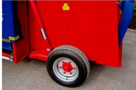
Mit Hydraulikzylindern auf beiden Seiten wird die Maschine zum Transport angehoben.
