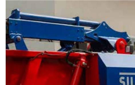
Der Doppelrohr-Teleskoparm ist in Spezialbuchsen gelagert und ermöglicht die Entnahme auch aus großen Höhen.
