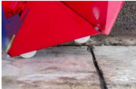
Schräges Abweisblech mit Rollen: einfaches Rangieren und somit keine Futterreste an der Silowand.
