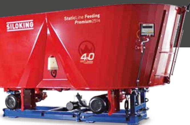
Der Antrieb der Turbo-Schnecken erfolgt jeweils über einen Elektromotor, der geschützt unter dem Mischbehälter platziert und an das Planetengetriebe angeflanscht ist.
