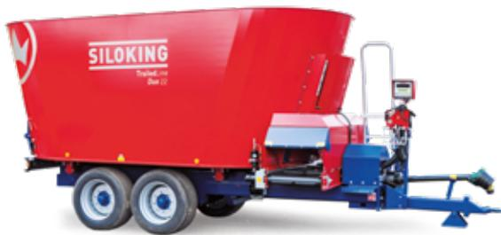
Für hohe Belastung und lange Fahrwege kann der SILOKING **TrailedLine Classic Duo** auch mit einem Tandemaggregat ausgerüstet werden.
