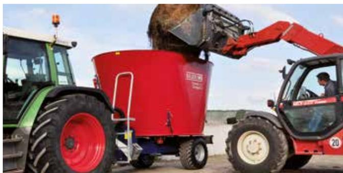
Durch ihre Behältergeometrie und den robusten Antrieb eignet sich die Maschine neben den Standardmischungen auch hervorragend zum Auflösen von Rundballen und zum Zerkleinern von langfaserigem Futter.
