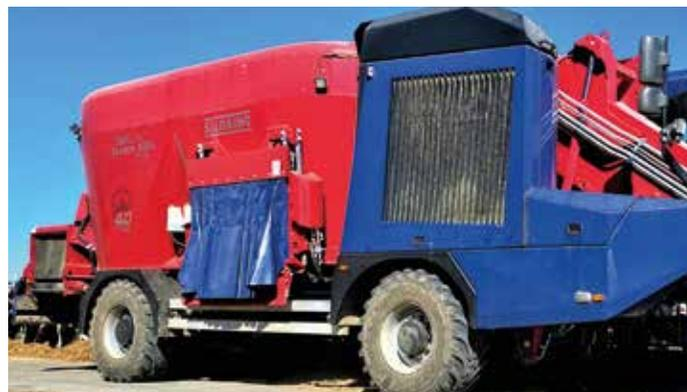
Klappbares Austragsförderband am Querförderband zur Beschickung von hohen Trögen.
