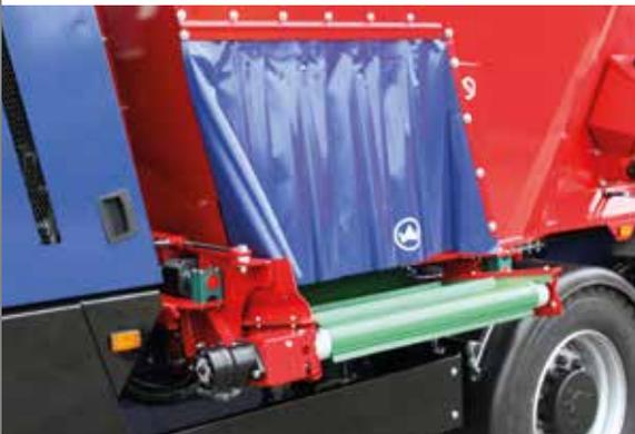
Das Querförderband hinten an der Maschine ermöglicht beim Stichfutterschneid die Futterablage auf kompletter Länge.
