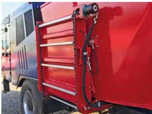
Heavy-Duty-Austragsschieber mit extra großer Öffnung sind besonders geeignet für langfaseriges Futter und zur direkten Futterablage neben der Maschine.
