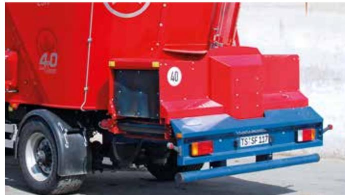
Das Querförderband hinten an der Maschine kann auch mit hydraulischer Seitenverschiebung ausgestattet werden.
