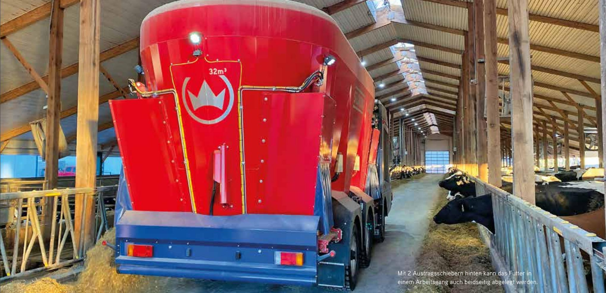
Mit 2 Austragsschiebern hinten kann das Futter in einem Arbeitsgang auch beidseitig abgelegt werden.
