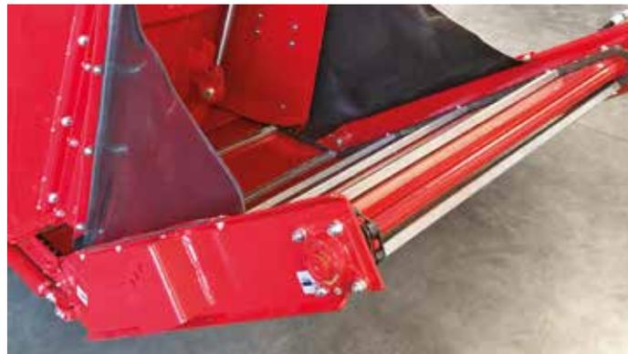
Die Austragsförderer werden einfach per Knopfdruck von der Fahrerkabine aus bedient.
