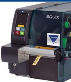
Es werden Endlosmaterialien wie Textil oder Schrumpfschläuche perforiert, um diese anschließend von Hand zu trennen.
