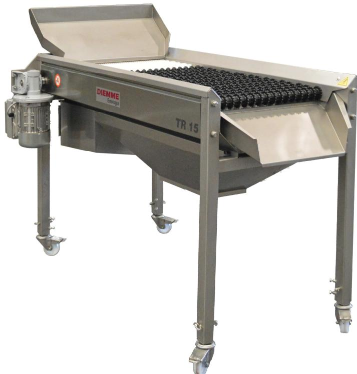
**D** Der Rollersortiertisch besteht aus einem Untergestell aus Edelstahl, welches in der Höhe verstellbar und mit drehbaren Räder ausgestattet ist. Er erlaubt, Fremdkörper mit Abmessungen größer als der Vollbeerendurchmesser, wie z.B. Traubenkämme und Blätter, abzutrennen. Die Einstellung des Abstandes zwischen den Walzen erfolgt durch Abstandsvorrichtungen. Dies ermöglicht die Verarbeitung von verschiedenen Beerengrößen.
