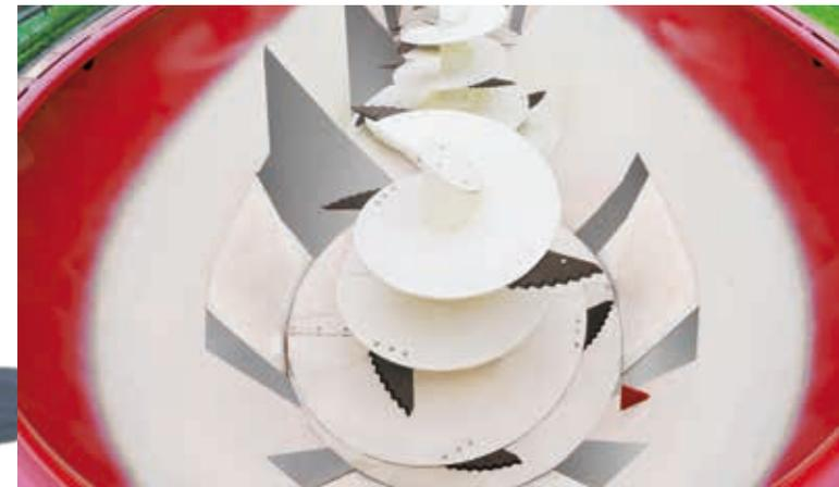
Standardmäßig sind die Modelle mit SILOKING Data T und SILONOX am Austrag und an den Behälterinnenkeilen ausgestattet.
