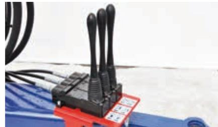
Steuergerät mit Bowdenzugbedienung.
