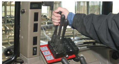
Optional: Mechanisches Steuergerät mit Hebelbetätigung inkl. Steuerung des Schaltgetriebes und manueller Regulierung der Förderbandgeschwindigkeit (Mengenteiler).
