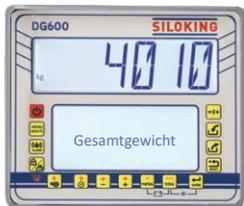
Optional: Mit der Programmierwaage DG600 können Rezepte erstellt und angelegte Be- und Entladeprogramme abgerufen werden.
