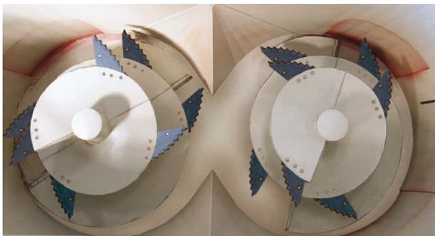
Die Turboflügel an den Turbo-Schnecken unterstützen den Mischvorgang und gewährleisten eine gleichmäßige und schnelle Entleerung.
