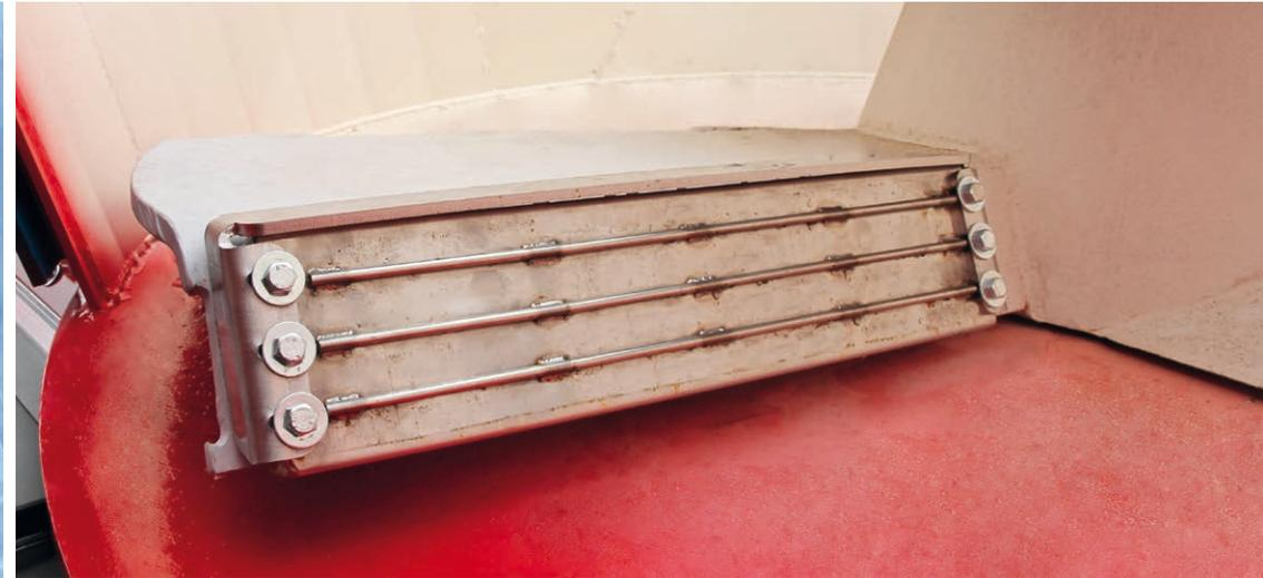
Schwerlastmagnet an der Turbo-Schnecke.
