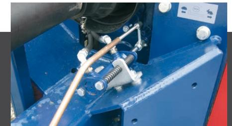
Hydraulische Umschaltung für Schaltgetriebe.
