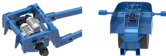
Hydraulische Federung an Front und Heck
