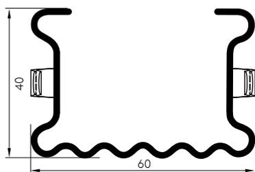
Der innovative Prägepfahl ist speziell für den Einsatz von Erntemaschinen konzipiert. Die patentierte Drahtsicherung verhindert ein unabsichtliches Ausheben des Spanndrahtes, die Erntemaschinen-schonende Profilkontur Beschädigungen an der Erntemaschine bzw. Deformationen an den Haken. So macht sich leova® HARVESTAR löwenstark für Ihren Ertrag!
